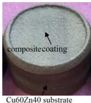
Figure 4-15. Photos numériques des pièces réparées: morphologie générale après projection CS.
