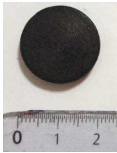
Figure 4.21 : Céramique micro-cellulaire SiBC10 m pressée avec le moule de diamètre 28,5 mm
