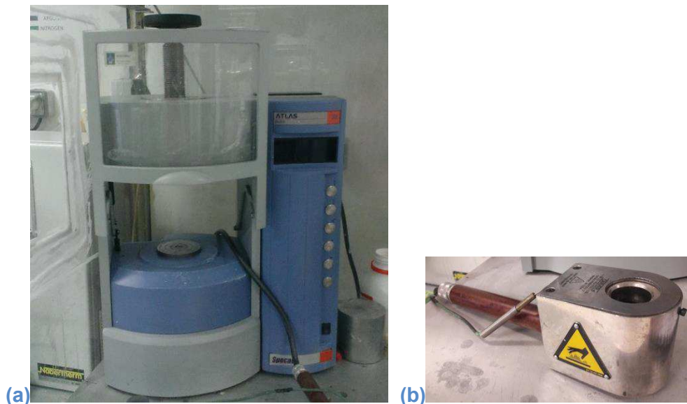
Figure 2.7 : Presse (a) et moule chauffant (b) utilisés pour le pressage uni-axial
