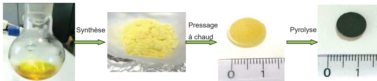
Figure 4.14 : Photographies des matériaux à chaque étape de leur élaboration du précurseur AHPCS aux objets massifs SiBC10 d
