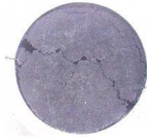
Figure 5.17 : Photographie du support en SiBC après essai à haute température
