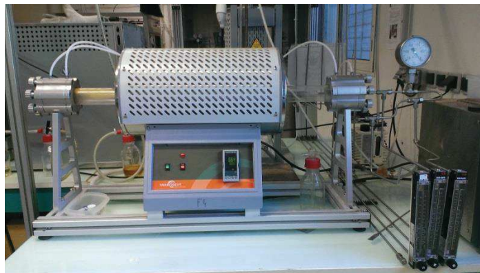
Figure 2.8 : Four de pyrolyse Thermoconcept de type OS50/450/12
