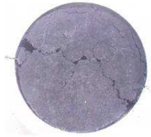
Figure 5.17 : Photographie du support en SiBC après essai à haute température
