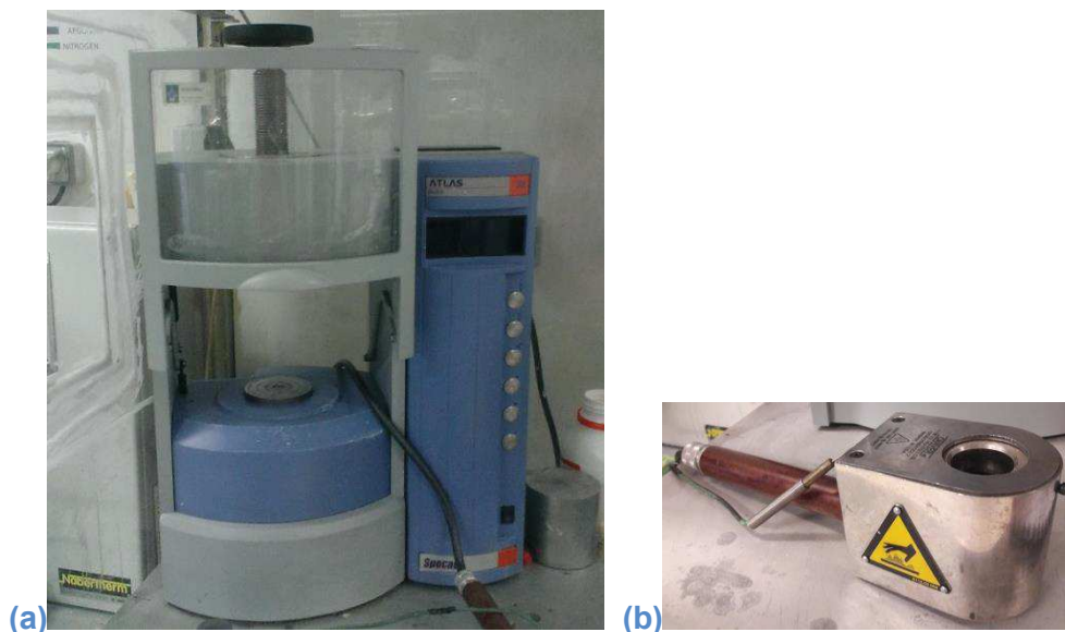
Figure 2.7 : Presse (a) et moule chauffant (b) utilisés pour le pressage uni-axial
