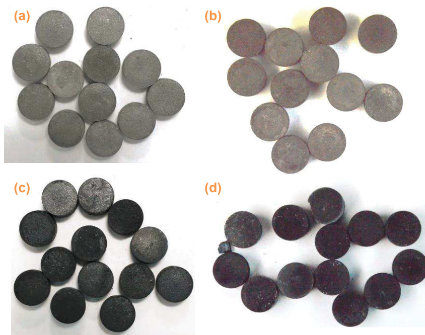
Figure 5.6 : Photographies de l'ensemble des échantillons SiBC10 m (a)(b) et SiBC13 m (c)(d) avant (a)(c) et après (b)(d) essais
