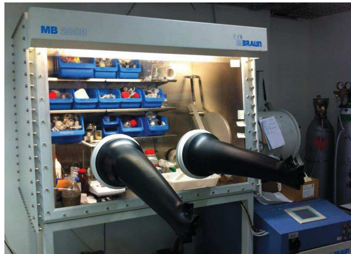
Figure 2.6 : Boîte à gants MBRAUN MB-200B
