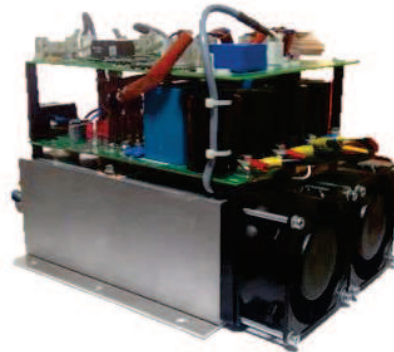
Figure V.7 : Exemples de convertisseurs de puissances utilisant des systèmes de refroidissement actifs
