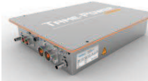
Figure V.7 : Exemples de convertisseurs de puissances utilisant des systèmes de refroidissement actifs
