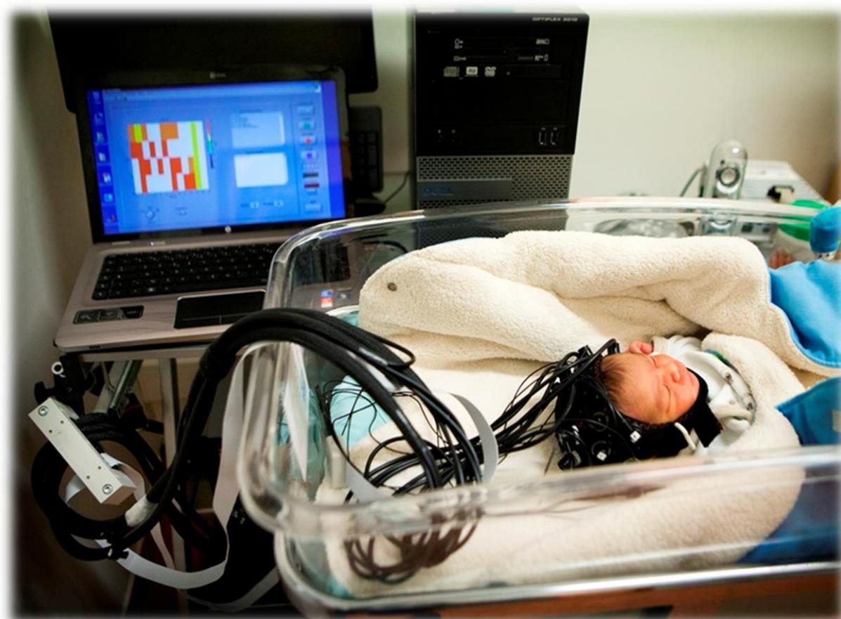
Figure 3.5 : Photod'un nouveau-né endormi dans son berceau et du dispositif juste avant le début de l'expérimentation, portant le bonnet avec les capteurs. Ces optodes sont reliés par des fibres optiques à la machine NIRSCOUT NIRx.
