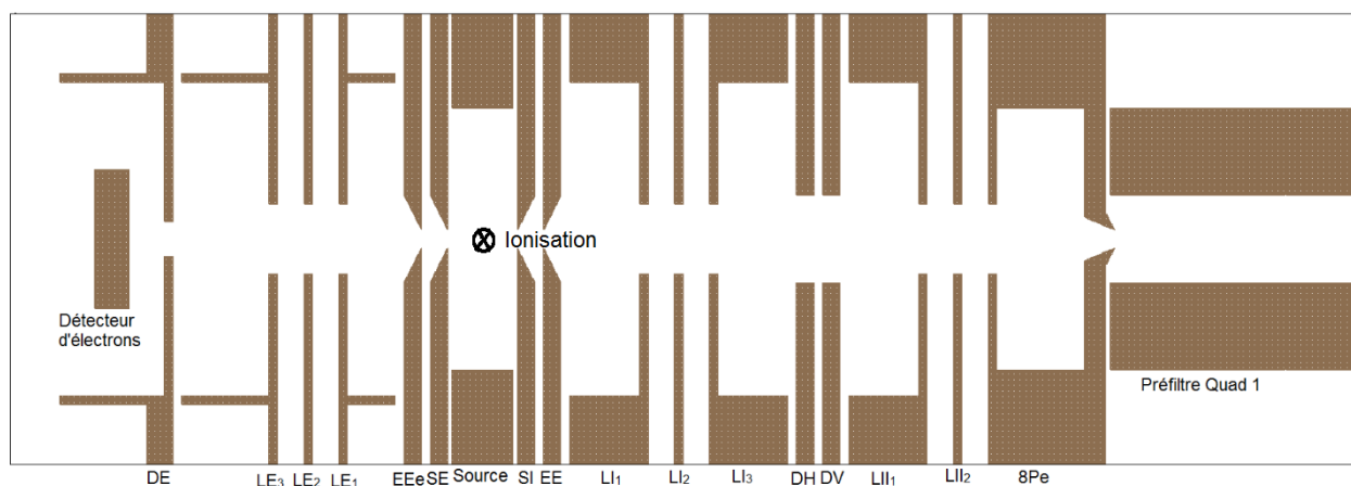
Figure II-9: Schéma en coupe de la source standard
