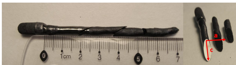
Figure 2.14 Photo du monocristal de composition SrCu_{0.99}Zn_{0.01}O_2 issu de la croissance cristalline utilisant une pastille de départ de composition CuO. Les plans miroirs très brillants correspondent aux plans de clivage [a,c] avec l'axe le plus long correspondant à l'axes des chaînes spins.
