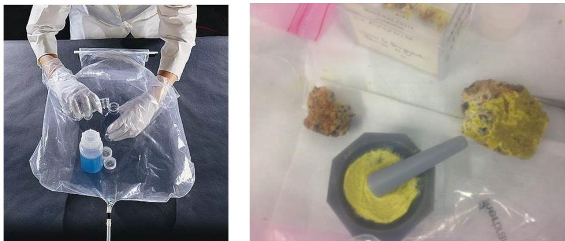
**Figure III-3 : Broyage des échantillons dans un sac à gants (Glovebag X-27-27 – Glas Col).**
