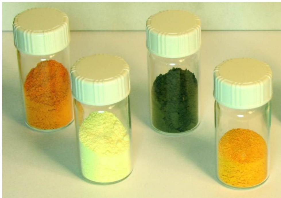
**Figure III-4 : Concentrés miniers de différentes natures cristallo-chimiques et couleurs.**
