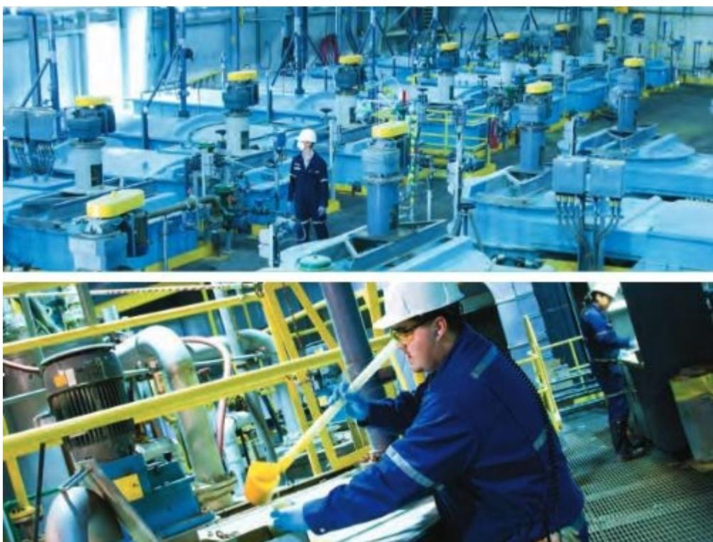
**Photo des installations d'extraction par solvants (haut) et de précipitation (bas) à l'usine de McClean Lake, Canada. Source : AREVA.**
