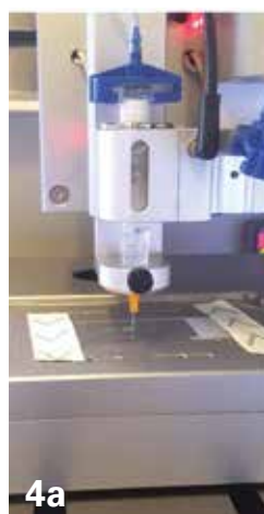
4a. Exemple d'imprimante à extrusion, en cours d'impression. b. Polymère imprimé sous forme de grille, à l'aide d'une imprimante à extrusion.
