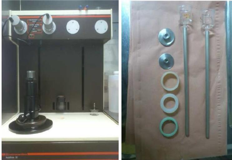
Figure II. 10 : Porosimètre à mercure Micrometrics-Autopore III 9420
