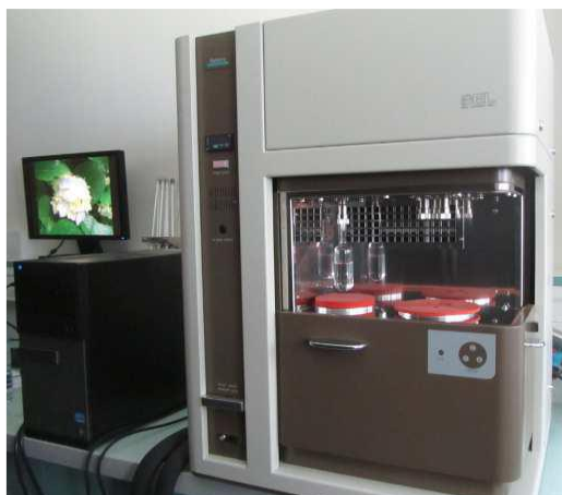
Figure I. 13 : Dispositif volumétrique de mesure des isothermes de sorption : Belsorp-aqua3
