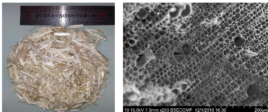
Figure II. 2 : Photo de la chènevotte utilisée, à gauche : en vrac et à droite : photo MEB
