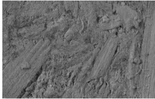
Figure III. 21 : Image déformée après humidification (75%HR, T=25°C)
