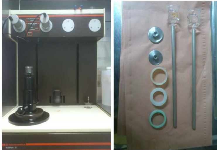
Figure II. 10 : Porosimètre à mercure Micrometrics-Autopore III 9420
