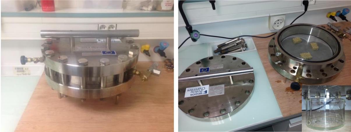
Figure II. 19 : Extracteur à membrane (modèle 10120 de Soil - Moisture Equipment Corp)
