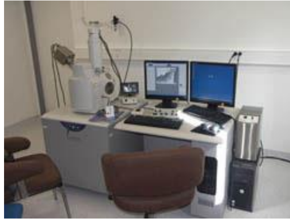
Figure III. 13 : Microscope électronique à balayage (MEB) au LMT-Cachan
