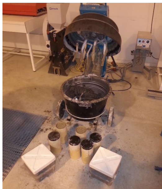
Figure II. 3: Malaxeur utilisé et forme des éprouvettes du béton de chanvre fabriqué
