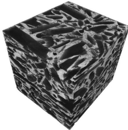
Figure III. 36 : Reconstruction 3D du béton de chanvre à une résolution de 17.1\*17.1\*17.1  $\mu m^3$
