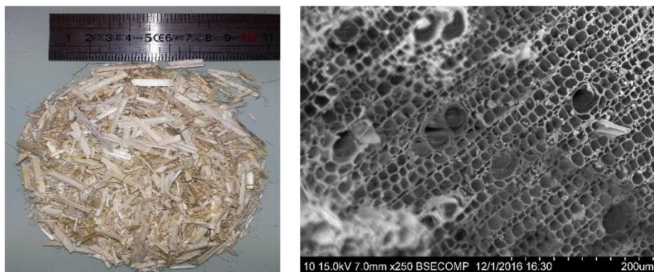
Figure II. 2 : Photo de la chènevotte utilisée, à gauche : en vrac et à droite : photo MEB
