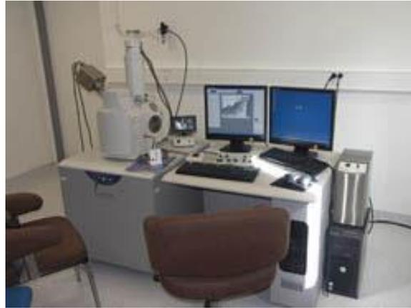
Figure III. 13 : Microscope électronique à balayage (MEB) au LMT-Cachan
