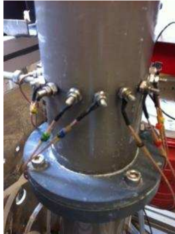
Figure 4. 8 : Photographie de la couronne d'électrodes du tomographe par résistance électrique
