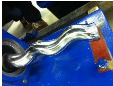
Figure 4. 7 : Rotor (vis excentrée) de la pompe de recirculation Mono
