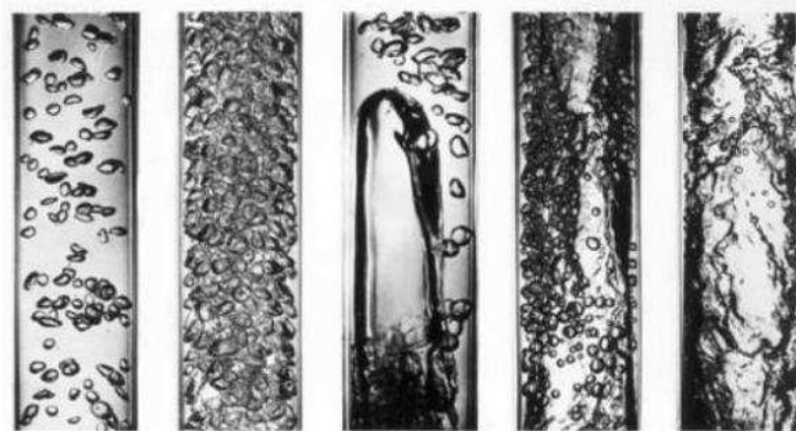
Figure 1. 13 : Les régimes d'écoulement de bulles d'air dans l'eau en co-courant ascendant lorsque le débit d'air augmente. De gauche à droite : écoulement à bulles dispersées, bulles agglomérées, à poches et pulsatiles (Ravelet 2014)
