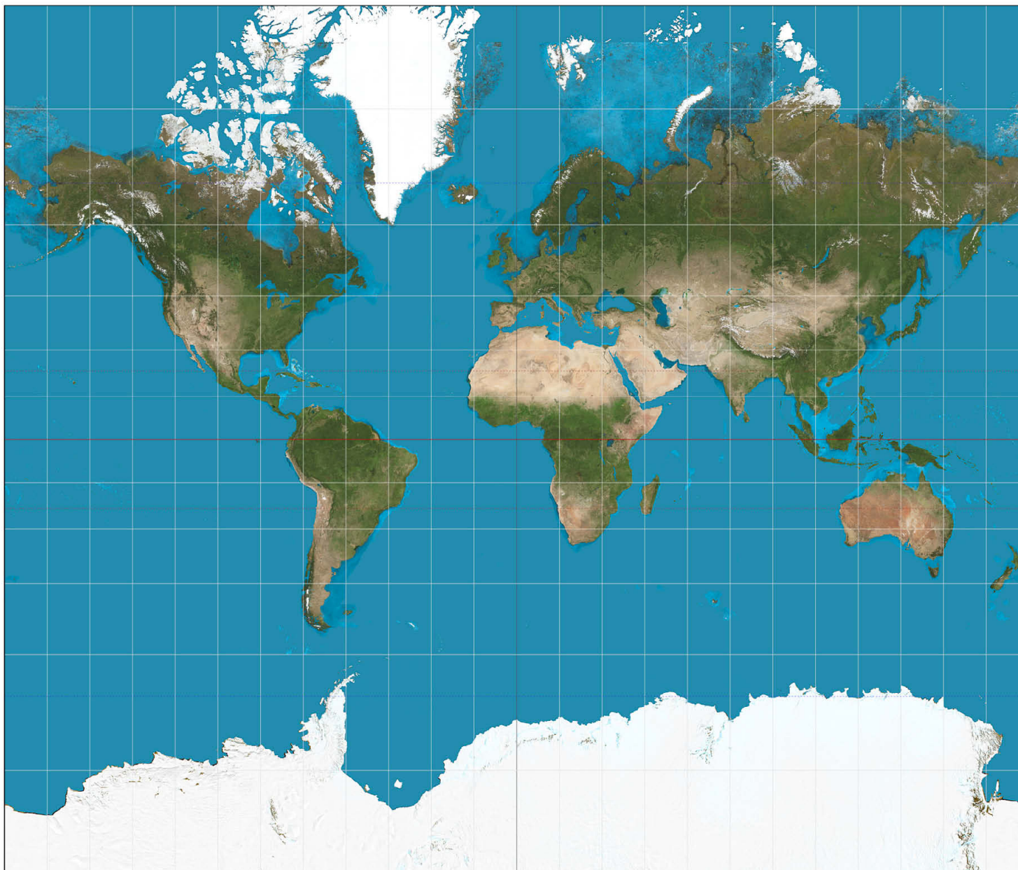
Fig.III. 03. Projection Mercator, basée sur l'imagerie de la NASA. La distorsion engendrée par la projection en s'éloignant de l'équateur est patente. Le Groenland apparaît aussi grand que l'Afrique, en dépit du fait que cette dernière est 14 fois plus grande.
