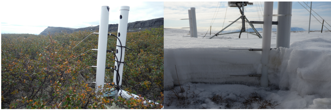
FIGURE 2.16 – Sondes de conductivité thermique fixes. À gauche : aiguilles TP02 de la station UmiTundra pliées lors de la fonte, au milieu d'arbustes de bouleau glanduleux mesurant environ 30 cm (Umiujaq, octobre 2014). À droite : sondes TP08 du site BylSta à la fin de l'hiver (Bylot, mai 2014).
