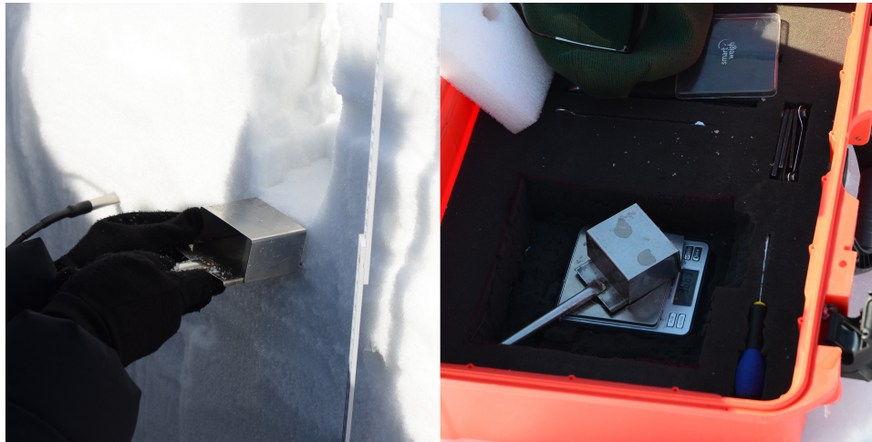
FIGURE 2.7 – Mesure de la masse volumique de la neige.
