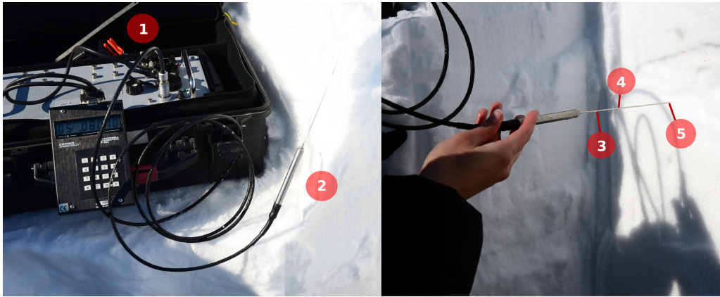
FIGURE 2.8 – Mesure de la conductivité thermique de la neige avec une aiguille chauffée TP02. (1) Centrale d'acquisition CR10X, (2) aiguille TP02, (3) résistance chauffante, et capteurs de température (4) chaud et (5) froid.
