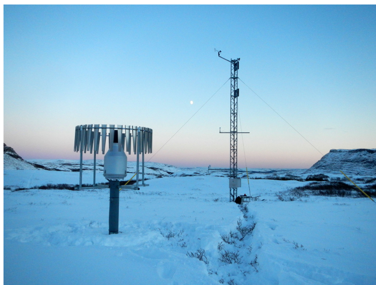
FIGURE 2.23 – Pluviomètre Geonor T-200B après avoir été déplacé, octobre 2014. Crédit : D. Sarrazin.
