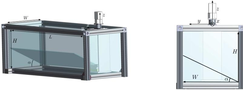
FIGURE V.6 – Dispositif expérimental de la géométrie de canal : Vue de perspective (figure de gauche) et de côté (figure de droite). Les paramètres utilisés pour cette expérience sont  $H = 360$  mm,  $L = 1000$  mm,  $W = 410$  mm et  $\alpha = 23^\circ$ .
