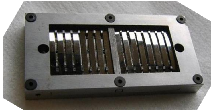
Figure A. 6 : Photographie du dispositif de flexion.
