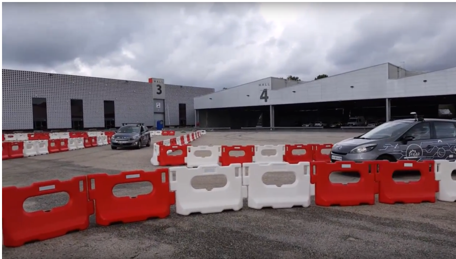
FIGURE 5.11 – Deux véhicules autonomes négocient leur droit de passage à l'intersection (un troisième véhicule non présent sur l'image se trouve également sur le circuit)
