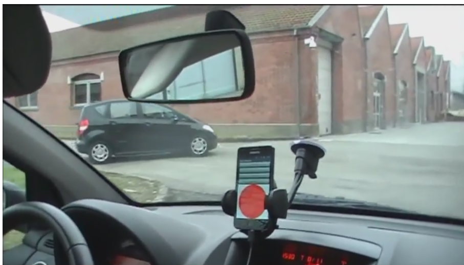
FIGURE 2.4 – Expérimentation du protocole CVAS en conditions réelles : un smartphone communique en WiFi avec le contrôleur d'intersection pour obtenir le droit de passage individualisé ; l'affichage rouge indique au conducteur qu'il n'est pas autorisé à franchir l'intersection
