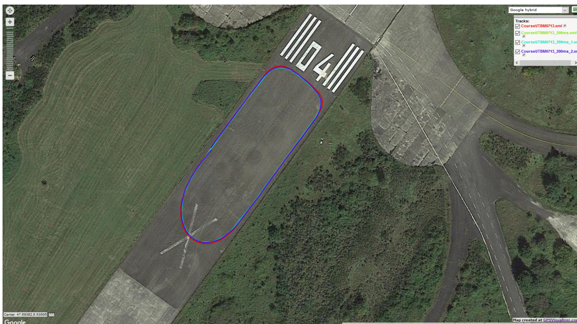
FIGURE 3.13 – Tracé GPS du circuit de référence en rouge, et tracés GPS réalisés en utilisant le contrôle latéral autonome
