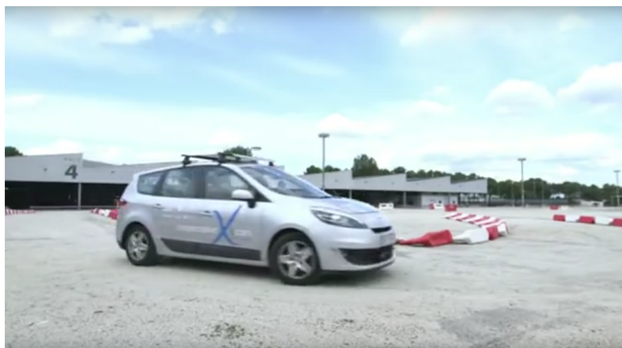
FIGURE 5.10 – Tests préliminaires de suivi de trajectoire sur le site du congrès ITS de Bordeaux : le véhicule suit une trajectoire prédéfinie et balisée en utilisant uniquement le positionnement satellite
