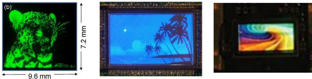
Figure I-41 : les premiers micro-écrans LED à matrice active (vert et bleu), rapportés en 2012 [50] et 2016 [49]. A droite le premier micro-écran LED couleur, rapporté en 2015 [88]
