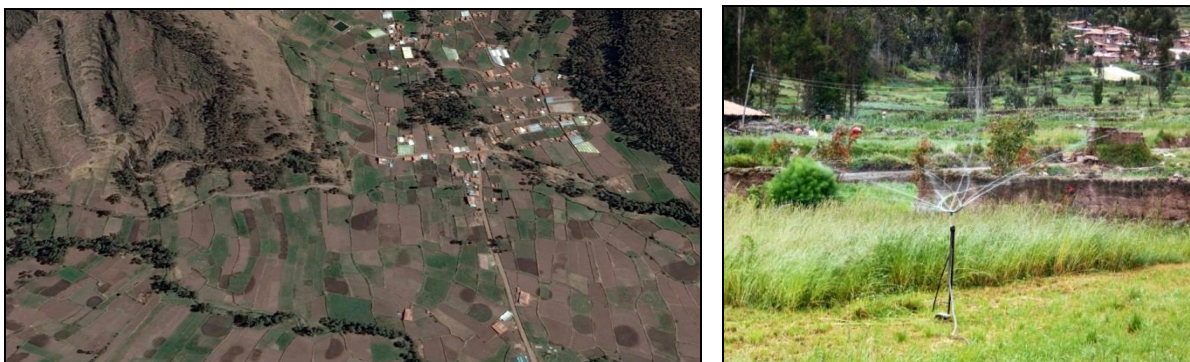
A gauche : Photographie satellite de la communauté de Sequeracay, près de Ccorao, sur laquelle on identifie les marques de l'irrigation par aspersion sur pied : les ronds sombres dans les parcelles, dans la moitié basse de l'image (Crédit : google earth). A droite : Système d'irrigation par aspersion observée dans de nombreuses parcelles de la communauté de Sequeracay, près de Ccorao (Jan. 20116) (Crédit : Margaux Girard).
