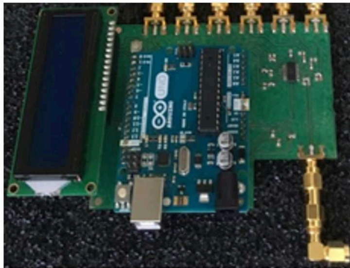
Figure 113: Prototype de la carte RF
