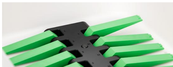
Figure II. 4 : Soulèvement d'un clapet suite à l'accumulation d'un volume précis de méthane
