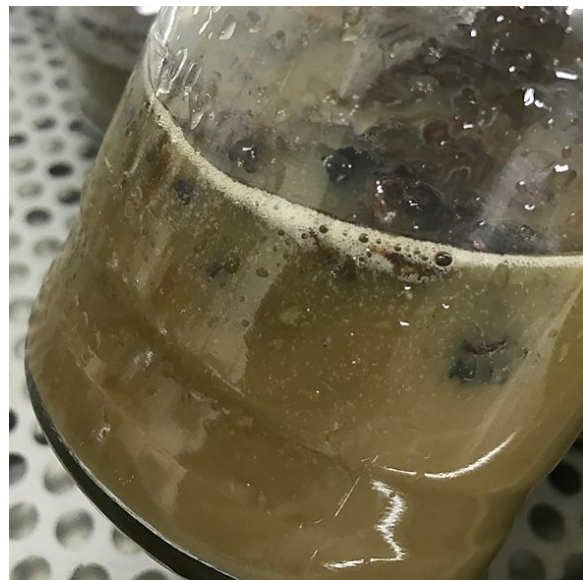
Figure VII. 2 : Dégagement des bulles de gaz à l'intérieur des digesteurs durant la digestion anaérobie du marc de raisin
