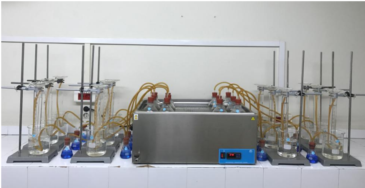
Figure VII. 1 : Unité de méthanisation en mode batch montée au sein de la faculté des sciences de l'Université Saint Joseph de Beyrouth
