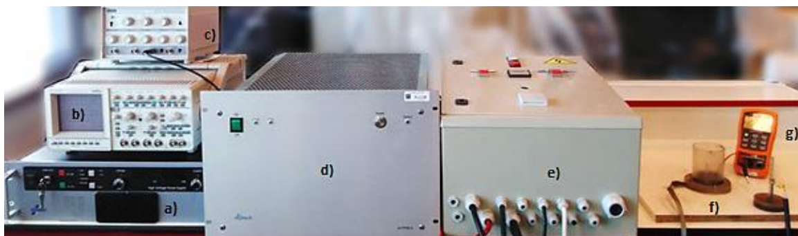
Figure II. 9 : Système de traitement CEP, générateur haute tension (a), oscilloscope (b), générateur d'impulsions (c), modulateur (d), boîte de mise à la terre (e), chambre de traitement (f) et impédance-mètre (g)
