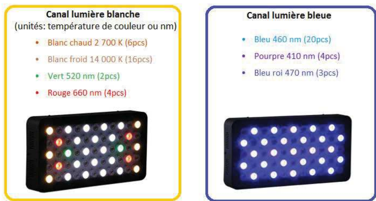
Figure 88 : Caractéristiques de la lampe permettant d'effectuer le stress lumineux associé à une lumière blanche ou bleue.
