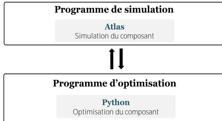
FIGURE II.8 – schéma illustrant le couplage du programme de simulation et d'optimisation.
