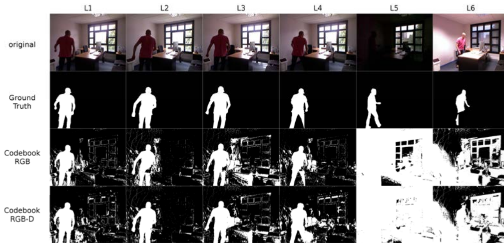
FIGURE 3.3 – Résultats de segmentations obtenues avec la méthode Codebook RGB et la méthode Codebook RGB-D avec un apprentissage sur la séquence L2 de la base “BUREAU”.
