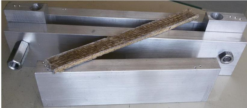
FIG. 5.2: moule en aluminium et échantillon après démoulage.
