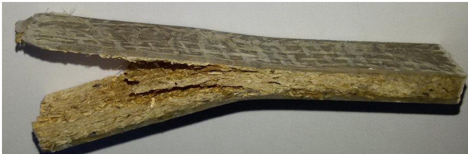
FIG. 5.4: sandwich simple d'une âme à 100% de chènevotte.
