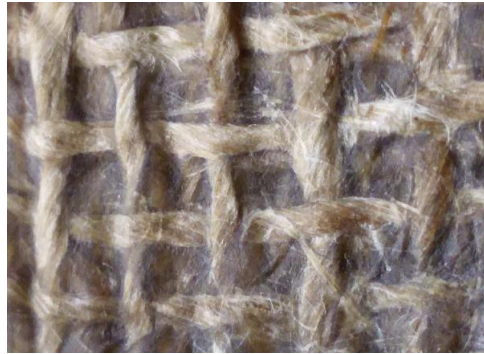
FIG. 4.37: écrasement entre la chaîne et la trame au milieu d'un échantillon de BD-COMP60.
