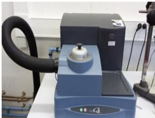
FIG. 3.11: machine de DSC et courbe de l'analyse calorimétrique de polystyrène recyclé par l'acétone.
