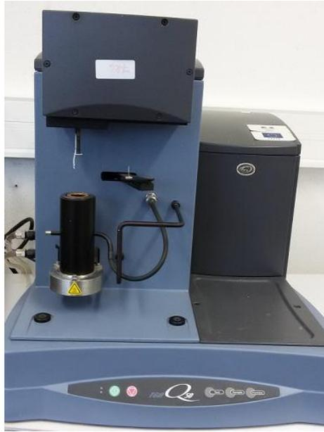
FIG. 3.16: machine de l'analyse Thermogravimétrique (TGA).
