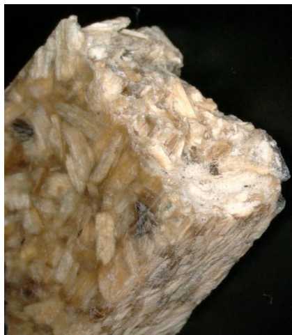
FIG. 4.10: section transversale d'un composite de chènevotte à matrice polystyrène.
