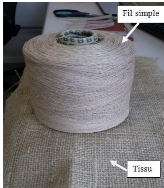
FIG. 3.2: fil simple et tissu de chanvre.
