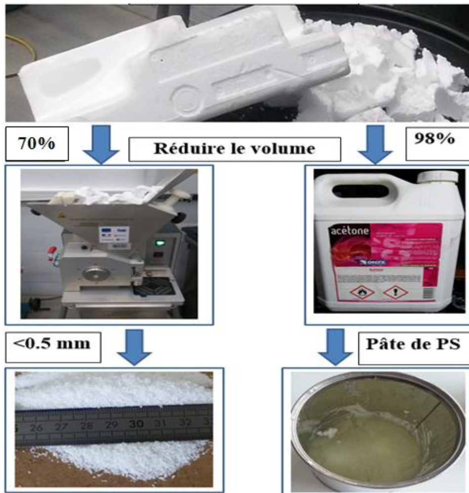
FIG. 3.4: recyclage du PSE par deux processus différent (par broyeur et par l'acétone).
