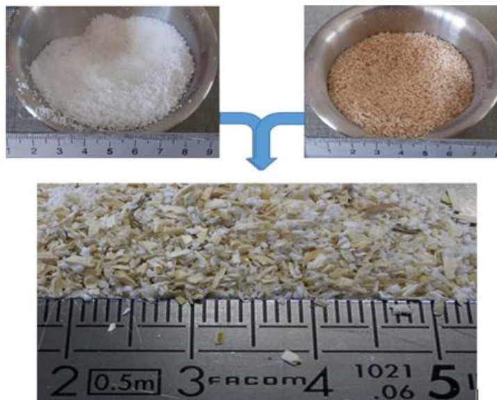
FIG. 3.8: mélange de la chènevotte avec la poudre de polystyrène (GrCOMP).
