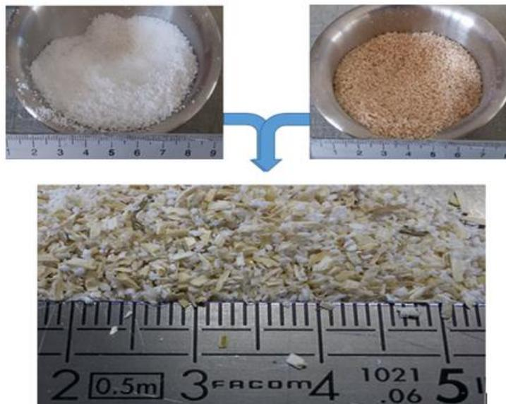
FIG. 3.8: mélange de la chènevotte avec la poudre de polystyrène (GrCOMP).
