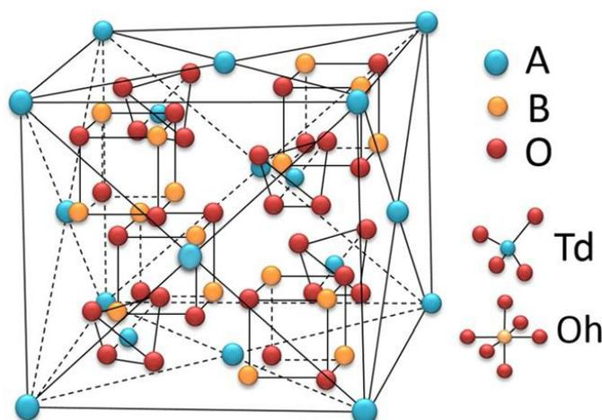
Figure 1.11. Spinel structure AB<sub>2</sub>O<sub>4</sub><sup>72</sup>
