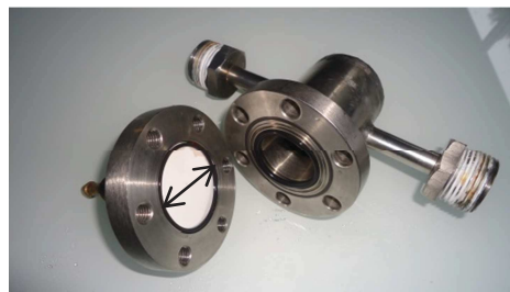
Figure 96 : Pilote de filtration frontale en continu avec recirculation
