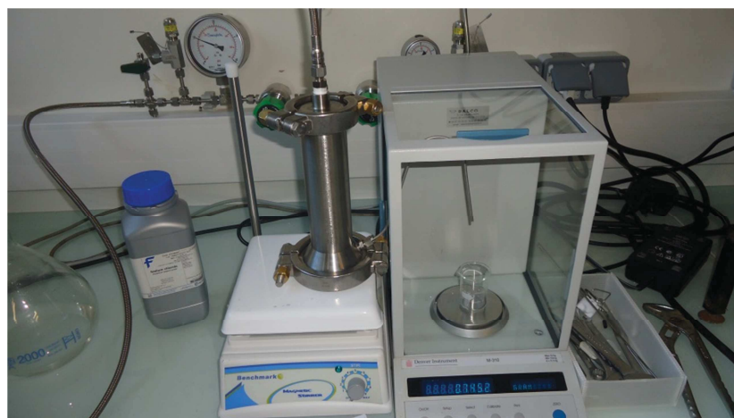
Figure 98 : Cellule Sterlitech™ HP4750 avec agitation pour filtration frontale
