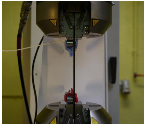
Figure 38. Dispositif d'essais et de suivi par émission acoustique
