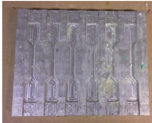
Figure 32. Moule pour fabrication des éprouvettes en matrice
