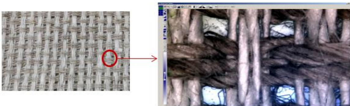
Figure 25. Observation détaillée de l'architecture du tissu
