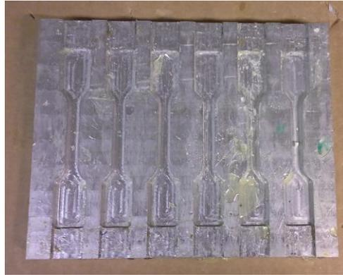
*Figure 32.* Moule pour fabrication des éprouvettes en matrice
