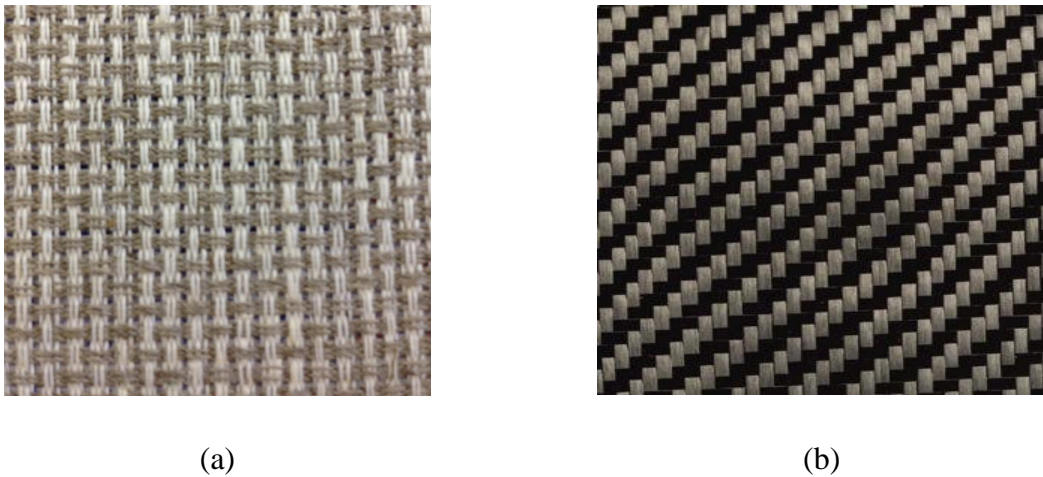
Figure 24. (a) Tissu de lin, (b) Tissu de carbone
