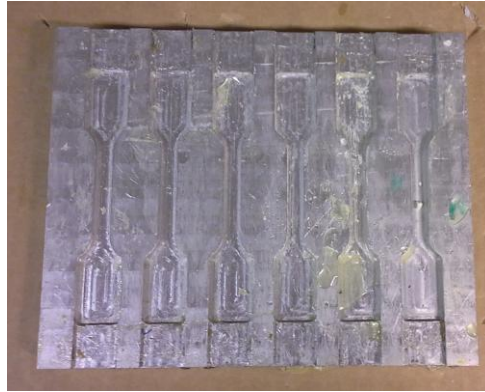
Figure 32. Moule pour fabrication des éprouvettes en matrice
