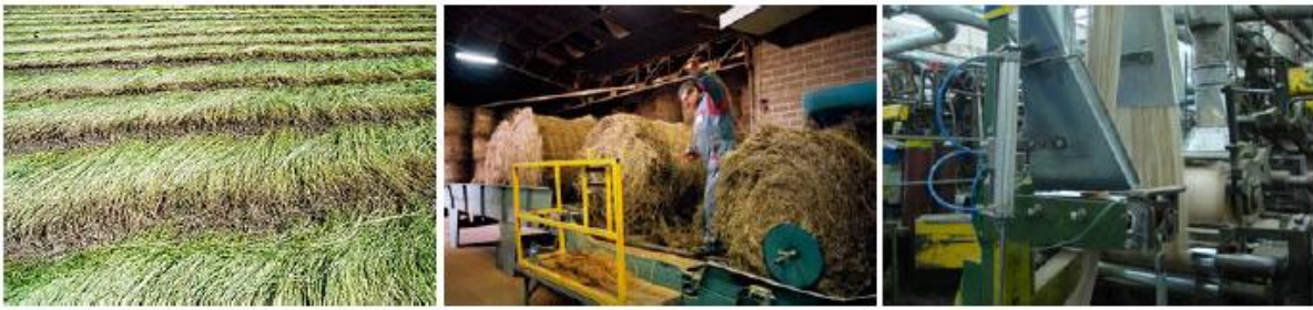
Figure 2. Etapes d'extraction du lin et de préparation à la filature : rouissage, teillage et peignage [19]
