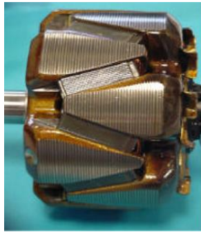
a. Machine synchrone à griffes [20]
