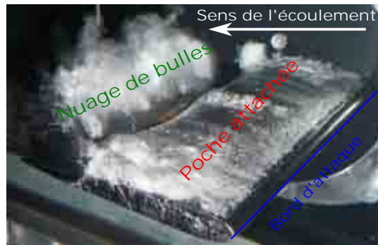
FIGURE 1.4 – Cavitation par poche sur le profil d'étude défini dans la section 3.3.2 du chapitre 5. ( Re = 8.0.10^5 , \sigma = 1.1 , i = 6^\circ ).
