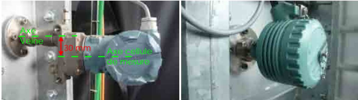
FIGURE 3.7 – Photos des capteurs de pression (à gauche) et de température (à droite) situés au niveau de la section carrée
