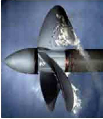
(a) Cavitation développée par bulles sur un propulseur marin (Naval Group (ex DCNS) - Bassin d'Essais des Carènes). L'écoulement se fait de la gauche vers la droite. Source : Franc et al. [50].
