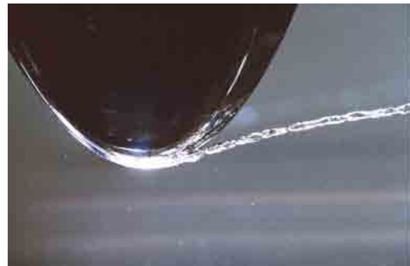
(d) Tourbillon cavitant d'extrémité d'aile pour un profil de forme elliptique et de section droite NACA16-020. Source : Boulon et al. [11]. ( Re = 4.55 \cdot 10^5 , \sigma = 1.26 , i = 8.9^\circ )
