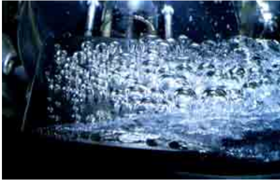
(a) Cavitation par bulles séparées sur un NACA16209. Source : Briançon-Marjollet et al. [15]. ( Re = 1.1 \cdot 10^6 , \sigma = 0.08 , i = 5^\circ )
