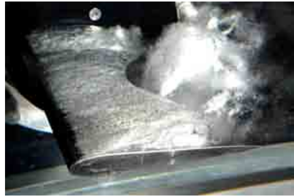
(b) Cavitation par poche sur le profil étudié dans cette thèse défini dans la section 3.3.2. ( Re = 8.0 \cdot 10^5 , \sigma = 1.1 , i = 6^\circ ).
