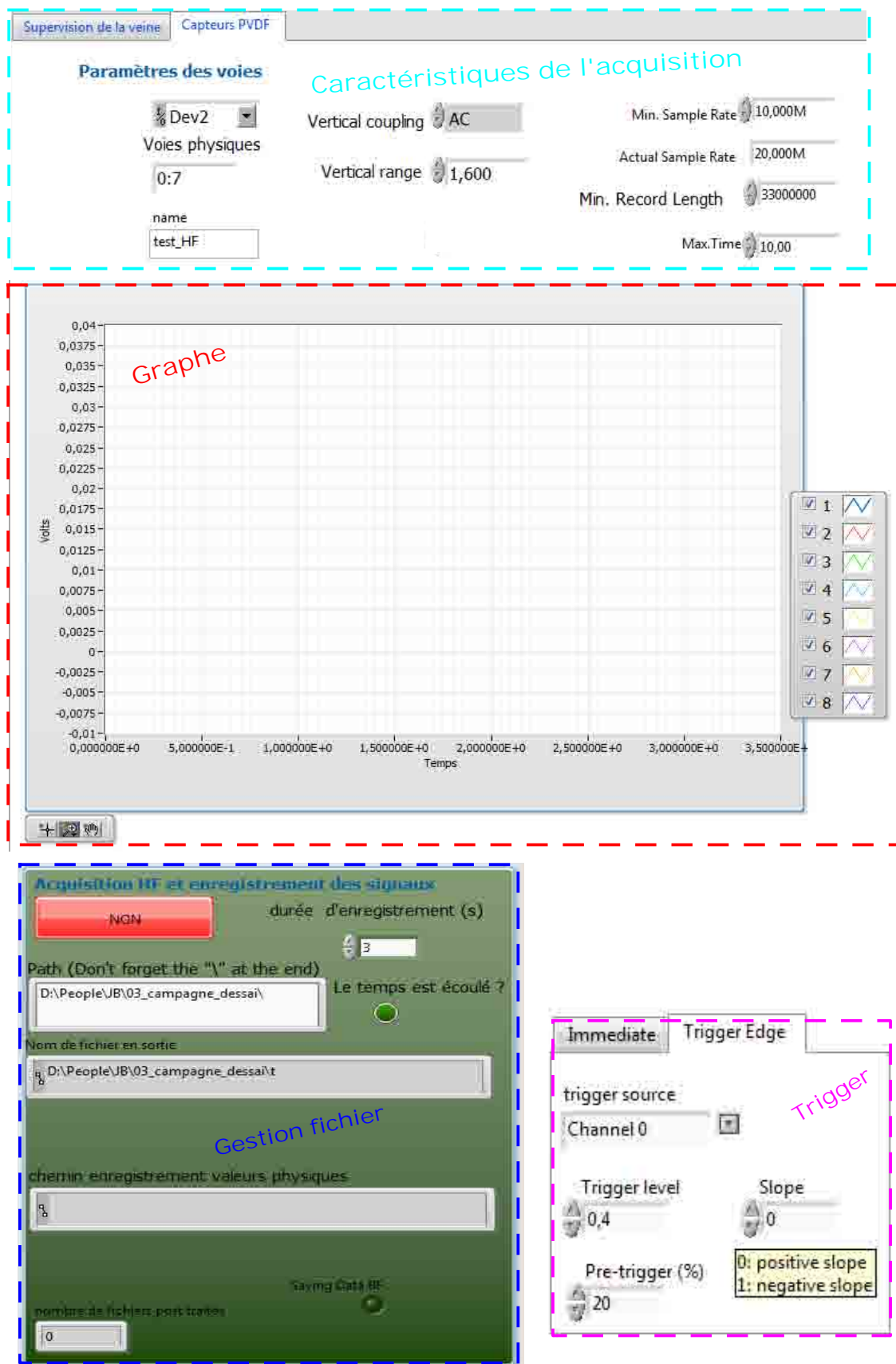
FIGURE 6.23 – Extrait de l'interface Labview du programme d'acquisition haute fréquence.
