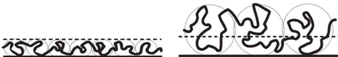
**Figure 4** : adsorption d'une chaîne chargée (à gauche) et d'une chaîne neutre (à droite) en interaction avec une surface.
