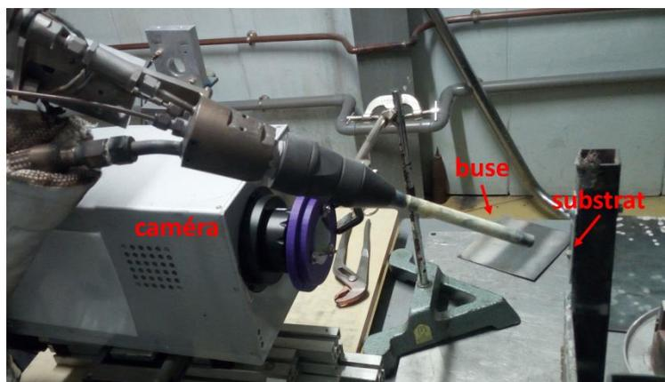
Figure 4-11 Système de mesure de la température des particules à l'impact
