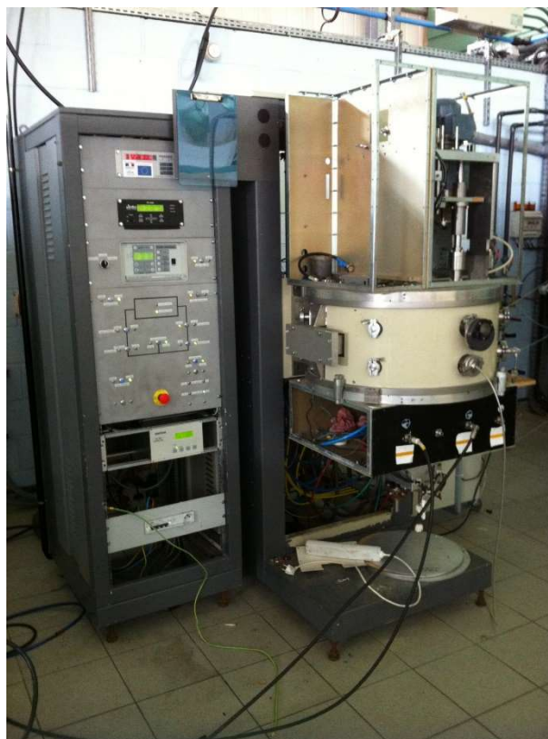
Figure 115 : vue d'ensemble du réacteur Alcatel SCM 650 équipé de 4 cibles de diamètre 200 mm.
