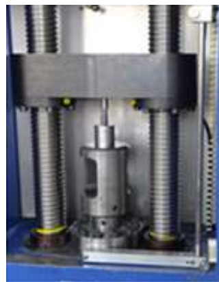
Figure 67 : Machine de traction Automatica de capacité 200kN.
