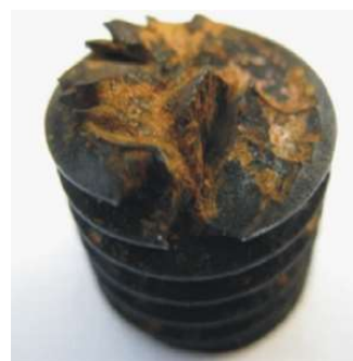
Figure 3 : propagation des fissures de la surface vers le cœur de la vis en milieu H_2S [5].
