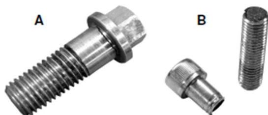
Figure 2 : Localisation des ruptures fragiles les plus courantes : a) sous tête et b) au raccord tige-filetage [4].
