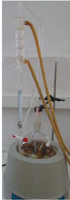
Figure 6 : hydrodistillation à l'aide d'un dispositif de type Clevenger
