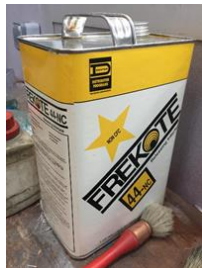
Figure D. 5. Couche de FREKOTE permettant de faciliter le démoulage de l'éprouvette.
