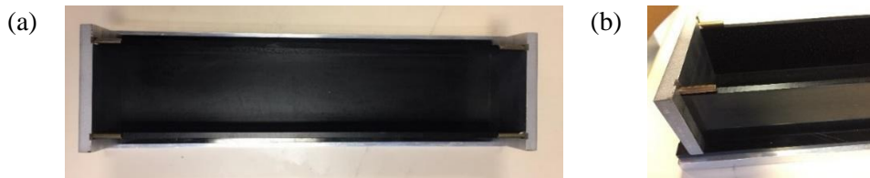
Figure D. 1. Moule des éprouvettes : (a) vue depuis le haut et (b) vue en 3D pour un bout du moule.
