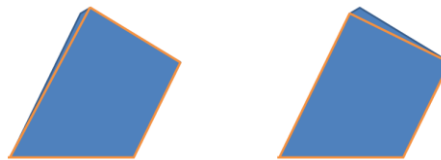
Figure 2. 18. Schéma de la méthode pour éliminer les très petits bords des polygones dans une géométrie de coupe.
