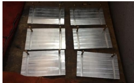
Figure D. 5. Couche de FREKOTE permettant de faciliter le démoulage de l'éprouvette.
