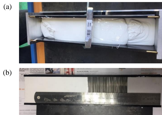
Figure D. 7. Exemples des difficultés du coulage de résine.
