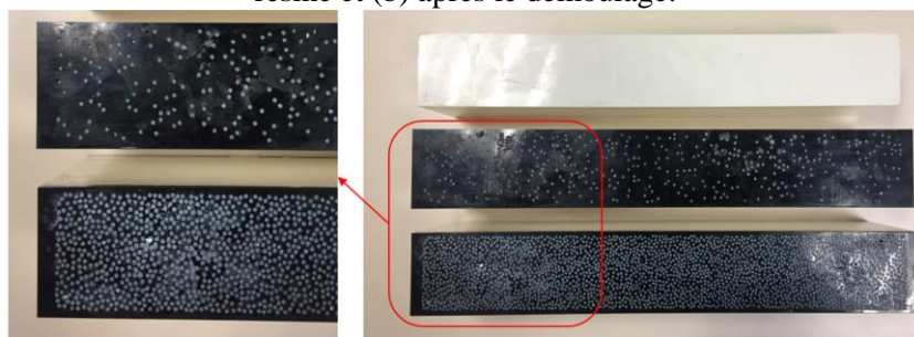
Figure 2. 23. Éprouvettes sans tiges, et avec des tiges à la fraction volumique de 5 % et de 30 % (de haut en bas).
