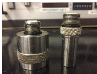
(a) Émetteur (gauche) et récepteur (droite). (b) Mesures des caractéristiques des transducteurs. Figure 3. 12. Transducteurs de fréquence nominale 1 MHz.
