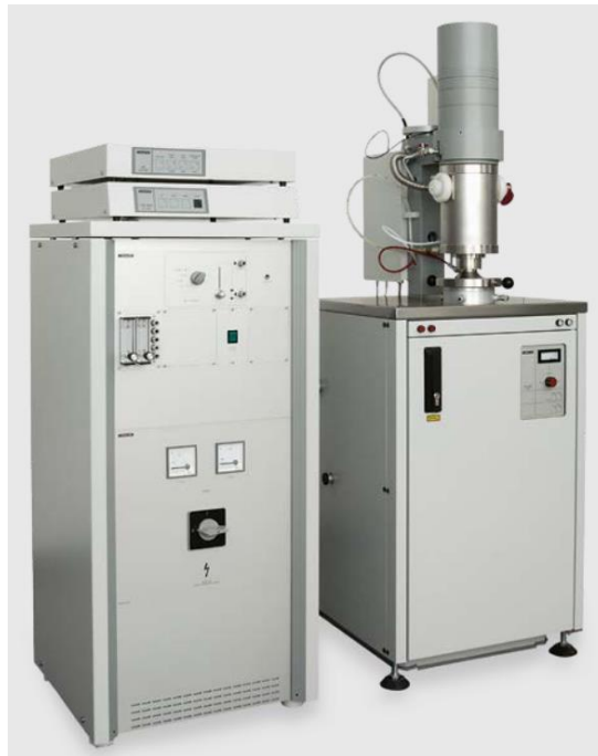
Figure II. 15 Dispositif de mesure de la diffusivité thermique (méthode LFA 427 - Netzsch)
