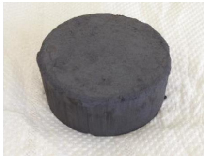
Figure III. 23 Photo du bloc de poudre obtenu avec addition de PVA
