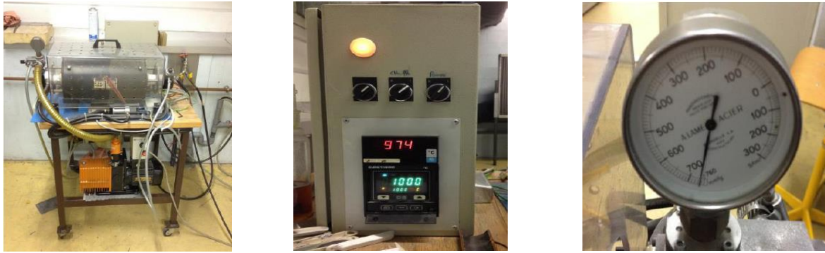
Figure III. 24 Photos du four sous vide, contrôleurs de température et pression
