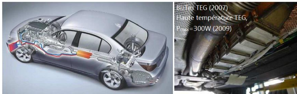
Figure I. 15 Générateur thermoélectrique produisant de l'électricité de la chaleur perdue au niveau du pot d'échappement d'un véhicule [78]
