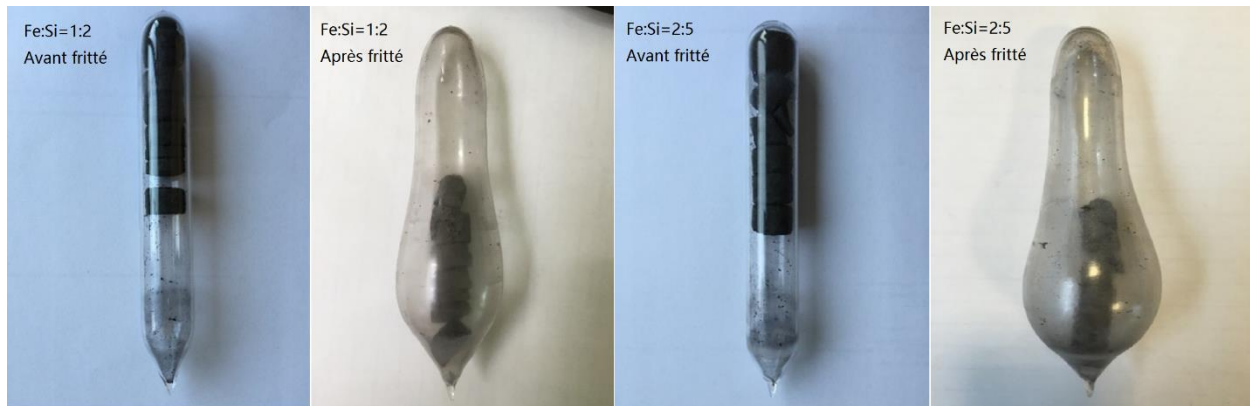
Figure III. 36 Dilatation du tube en quartz après frittage jusqu'à 1150°C pendant 7H et à 800°C pendant 5H
