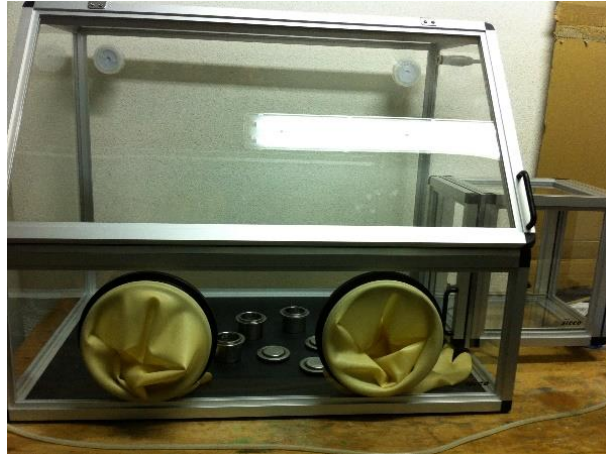
Figure II. 7 Boîte à gants sous atmosphère argon
