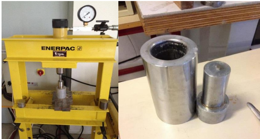
Figure III. 22 Photos de la machine de compression et du moule utilisé
