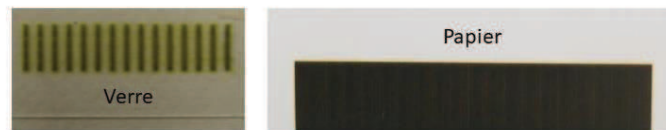
Figure III. 18. Photographies de quelques échantillons d'impression de (PEDOT) 0.03 V 2 O 5 sur verre (gauche) et papier (droite).
