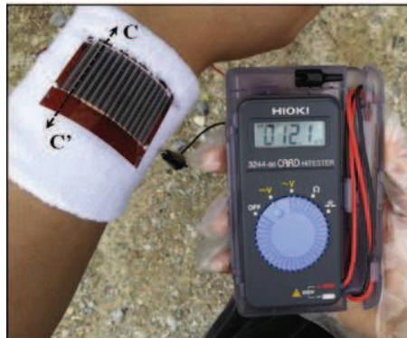
Figure I. 23. Conversion de la chaleur du corps humain en électricité à l'aide du dispositif à base des composites PEDOT:PSS/ \text{Sb}_2\text{Te}_3 et PEDOT:PSS/ \text{Bi}_2\text{Te}_3 .
