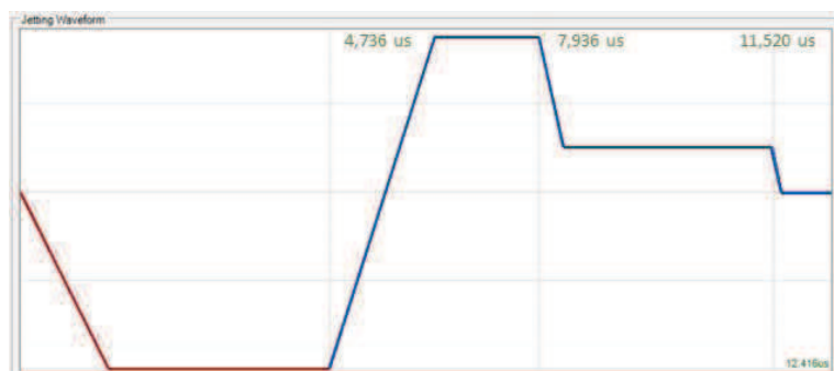
Figure III. 22. Profil d'onde électrique de génération de gouttes de TiS_2[(HA)_x(NMF)_y] .
