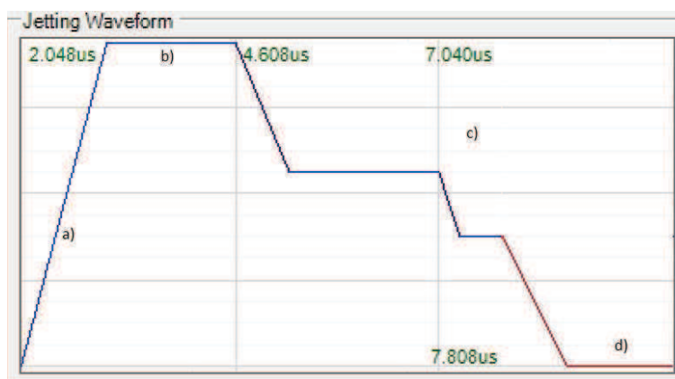
Figure III. 15. Profil d'onde électrique de génération de gouttes de (\text{PEDOT})_{0.03}\text{V}_2\text{O}_5 .
