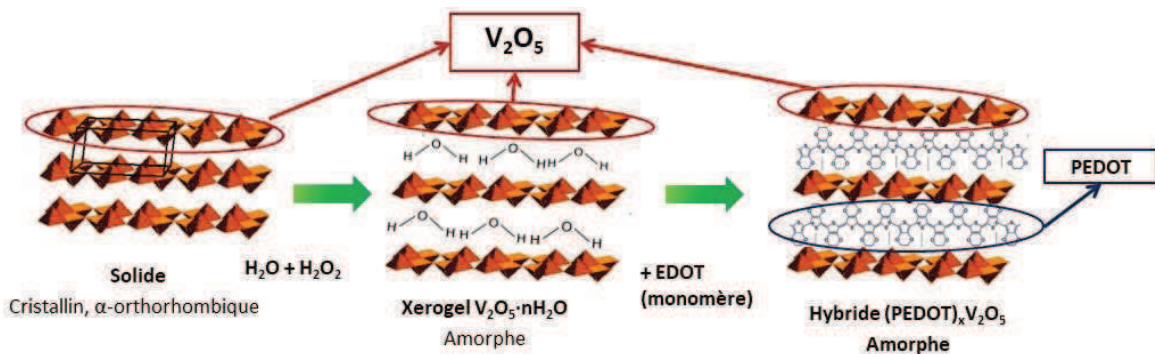
Figure II. 23. Principe d'intercalation du PEDOT et d'expulsion des molécules d'eau situées entre les plans du pentoxyde de vanadium.
