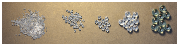
FIGURE 2.5 – Quelques billes utilisées dans cette thèse. Diamètres (de gauche à droite) : 1.5 mm, 3 mm, 5 mm, 8 mm et 10 mm.
