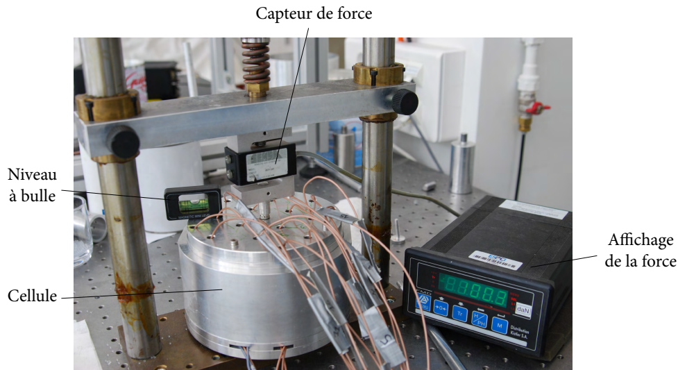
FIGURE 2.3 – Vue de la cellule instrumentée : la cellule est mise sous contrainte verticale grâce à une presse (manuelle ici) et la force est mesurée grâce à un capteur de force.
