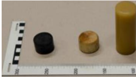
Figure 1-14 : des projectiles bâton, de 37 mm. A gauche, un projectile en caoutchouc de 28 g, au milieu un projectile en bois de 32 g, à droite un projectile en plastique de 134 g (le L5) [ROB_2013]
