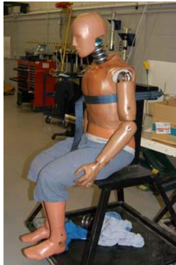
Figure 1-38 : un modèle du mannequin Hybrid III [FOR_2005]
