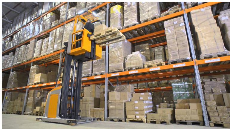
FIGURE 2.4 – Un chariot élévateur collectant uniquement sur le coté
