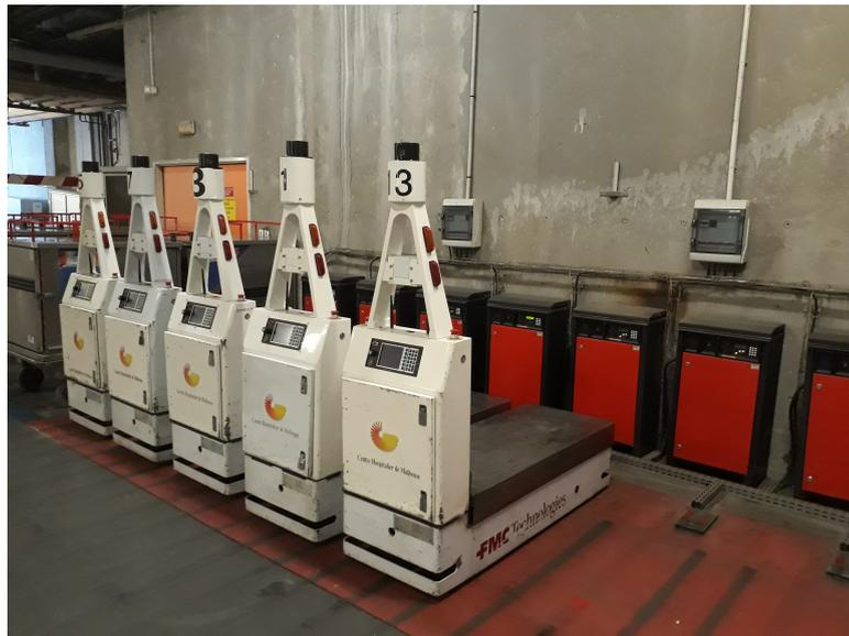
FIGURE 1.8 – Des AGV sur leurs stations de recharge
