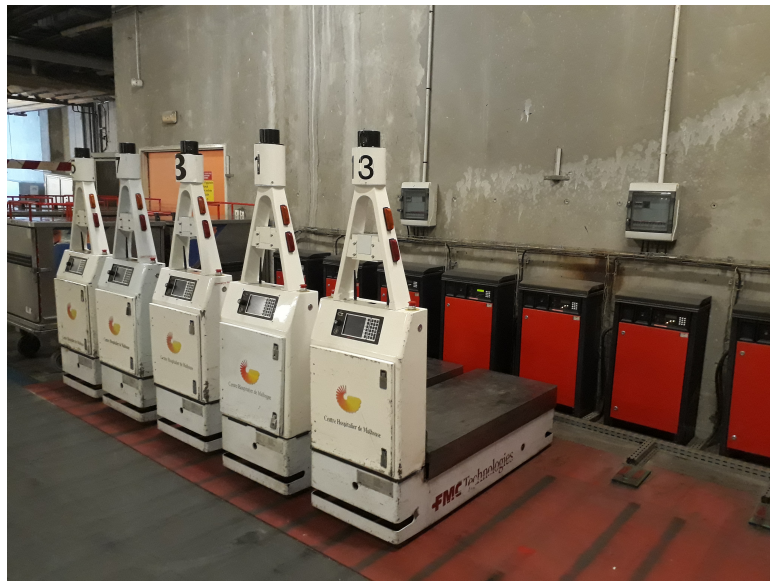
FIGURE 1.8 – Des AGV sur leurs stations de recharge
