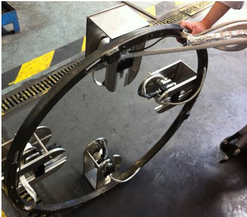
Figure III. 5 : Photographie de l'instrumentation complète sans les carters de protection.
