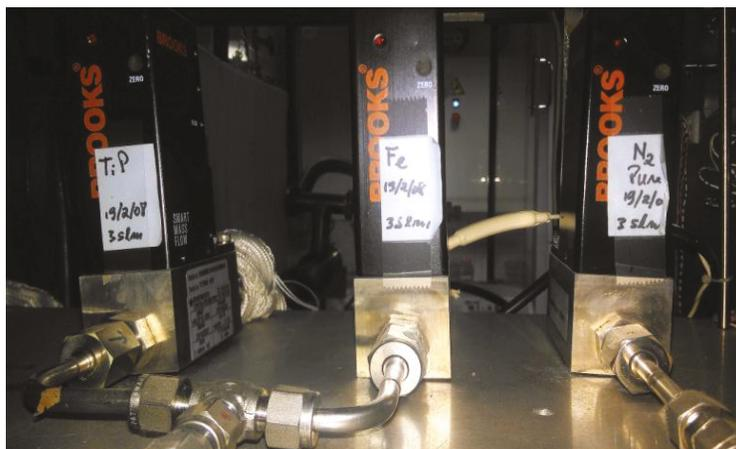
*Figure VI-7. Débitmètres massiques de TIP, ferrocène et azote.*
