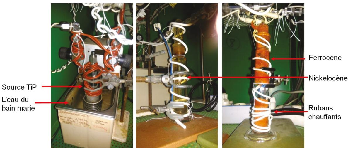
*Figure VI-6. gauche : Source de précurseur TIP ; centre : nickelocène et droite : ferrocène.*
