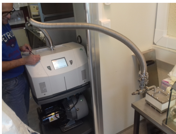
FIGURE 2.10 Dernière étape : pompage et test de fuite.
