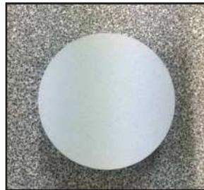
**Figure IV.2.** Photographie d'un échantillon d'acier inoxydable revêtu de composite  $Al_2O_3$ -Fap par projection "APS"
