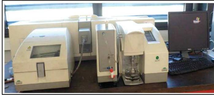
**Figure II.8.** Photographie de l'unité de mesure de granulométrie à la plateforme du laboratoire LERMPS
