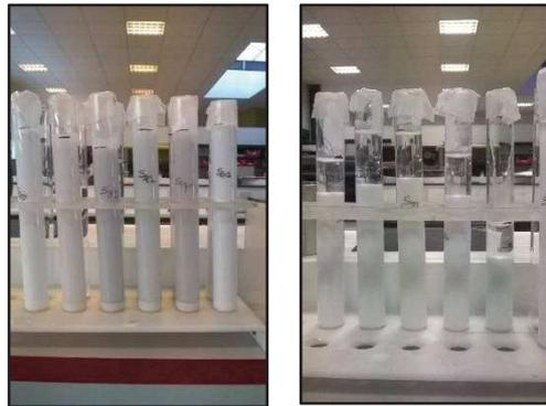
**Figure II.6.** Test de sédimentation dans des tubes à essai : a : suspensions bien dispersées
