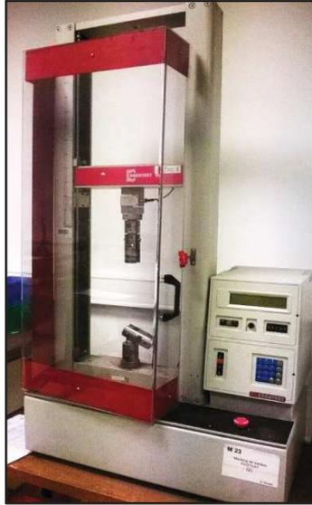
**Figure II.12.** Photographie de l'unité de mesure de l'adhérence mécanique à la plateforme du laboratoire LERMPS (site Sevenans)
