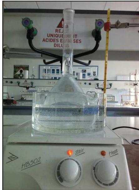
**Figure II.21.**Préparation de la solution SBF
