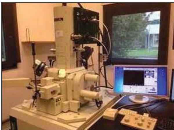
**Figure II.7.** Photographie du MEB à la plateforme du laboratoire LERMPS située à Montbéliard
