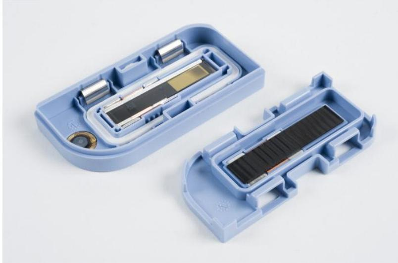
**Figure 6 : Dosimètre utilisé pour la dosimétrie individuelle passive (IRSN)**
